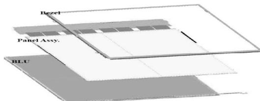
而背光模組的結構主要有光源、導光板、稜鏡片、擴散片、反射膜及背板等，其中背板(Back cover)是整個背光模組的主要支撐結構，同時亦作為電磁波干擾的屏障，並促進散熱及使溫度均勻化，避免局部溫度過熱，所以使用的材料除了要滿足上述的特性要求，亦需提供足夠之機械強度，且能承受複雜的加工形狀。而背光模組的結構是以膠框為主體，再搭配一些光學模片(Optic Film)、導光板及燈管組(Lamp Assy-包括燈罩、燈管罩(Shielding)...)，因此整個模組其實就是框架結合膠框來包住所有部件，而框架(Bezel)又比膠框堅固且設計較為簡單，因此框架(Bezel)及背板(Back Cover)的設計便成為 TFT-LCD 整體架構中極為重要的一環。
